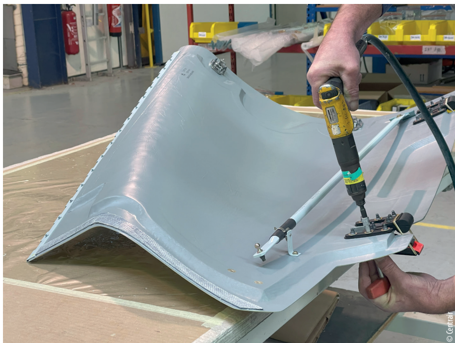
Assemblage d'une porte de soute d'hélicoptère
